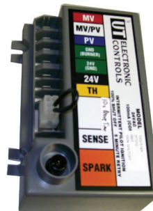
Figure 25. Contrôleurs d'allumage obsolètes
